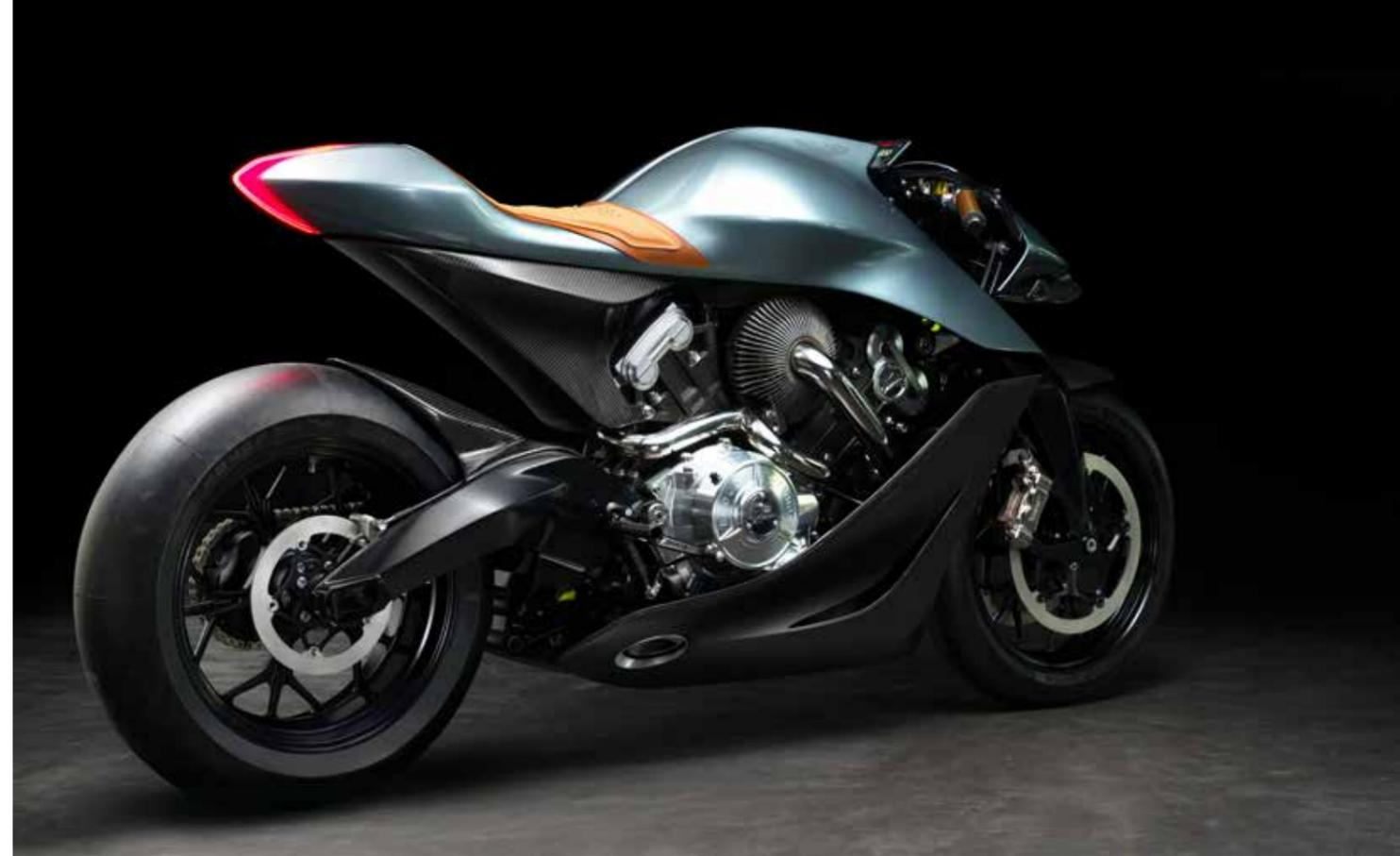
Mit der AMB 001 präsentieren Aston Martin und Brough Superior ein einzigartiges, modernes, leichtes und leistungsstarkes Sportfahrradkonzept mit exklusiven technischen Merkmalen, darunter eine Fahrwerkskonfiguration mit Doppelquerlenker-Vorderradgabel und Carbonstruktur.
