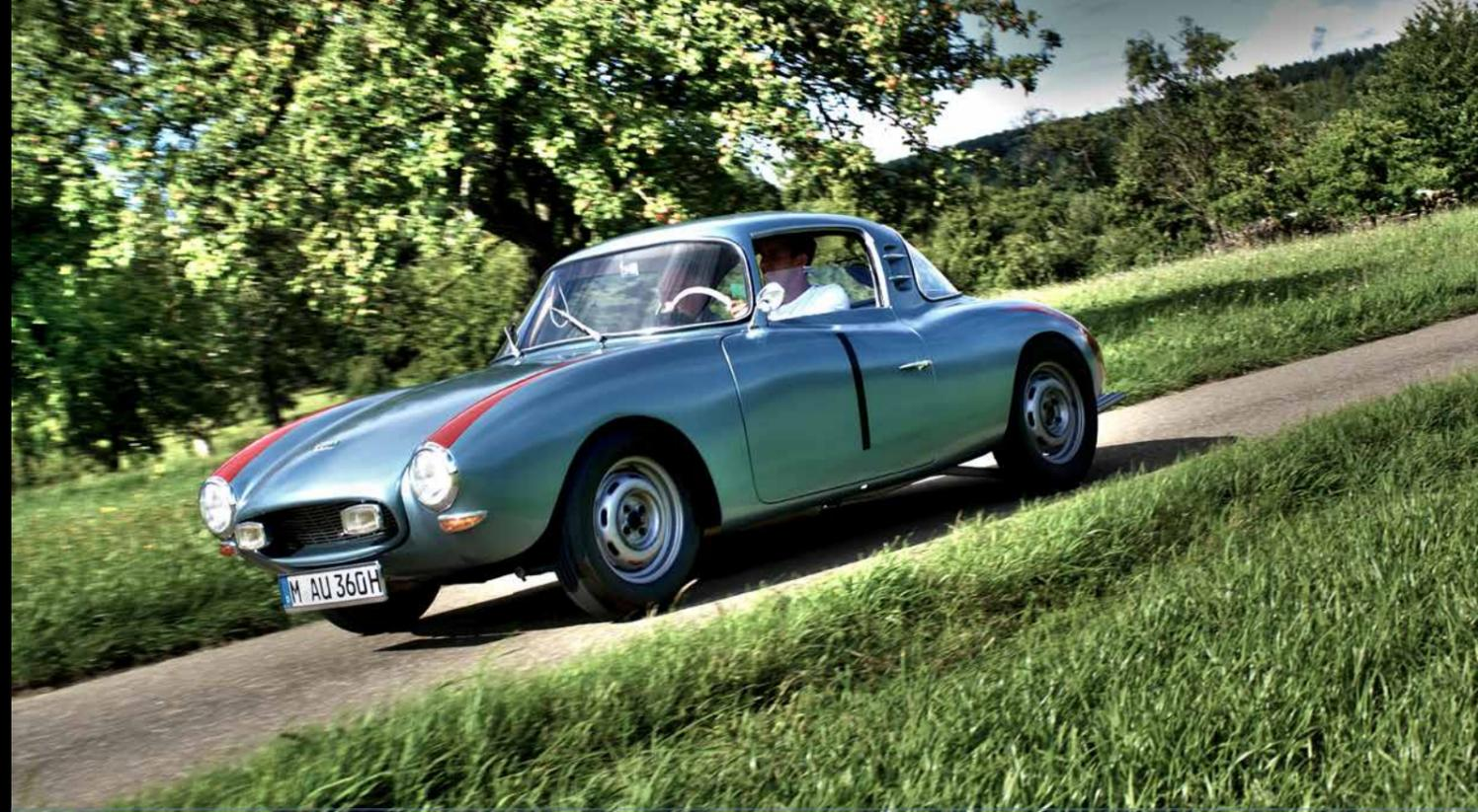
Nach einigen Rennerfolgen der DKW 3=6 Sonderklasse bei europäischen Touring Rennen und Straßenrallyes entschieden sich die beiden Rennfahrer Günther Ahrens und Albrecht W. Mantzel zum Bau eines extrem leichten Kunststoff-Aufbaus auf dem Chassis eines DKW F93. Die ersten Fahrzeug-Aufbauten, wie der Rekordwagen wurden bei Dannenhauer & Strauss gefertigt. Bei dem hier gezeigten Fahrzeug handelt es sich um die Nummer sechs der acht gebauten Prototypen.
