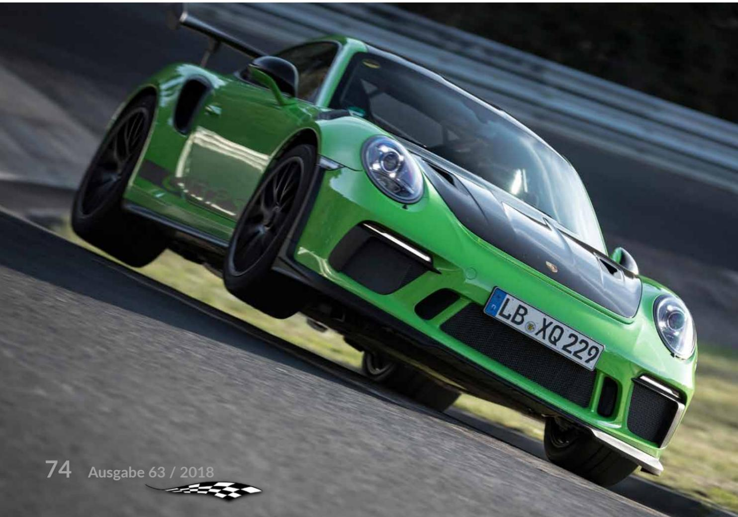
Der 911 GT3 RS mit einem Motorsport-Chassis und einem 520 PS (383 kW) starken Vierliter-Ansaugmotor feierte dieses Jahr Anfang März auf dem Genfer Automobilsalon Weltpremiere. Der Hochleistungs-sportwagen beschleunigt in 3,0 Sekunden von 0 auf 60 mph und erreicht eine Höchstgeschwindigkeit von 193 mph.
