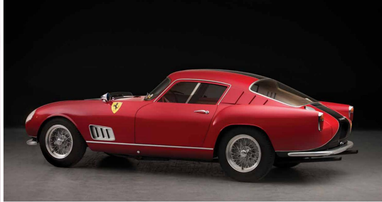
Dieser Mid-Production TdF ist das 15. von 17 Exemplaren, die im Body-Style von 1957 gebaut wurden – mit drei Luftschlitzen und verdeckten Scheinwerfern. Zum Produktionsbeginn Ende 1957 wurde der Motor mit Renn-Nockenwellen tipo 130 und Hochkompressionskolben ausgestattet. Am 2. Januar 1958 wurde der Motor fertiggestellt und am 4. Januar getestet. Der Test bestätigte eine Leistung von 258,2 PS bei 7.200 U / min.
