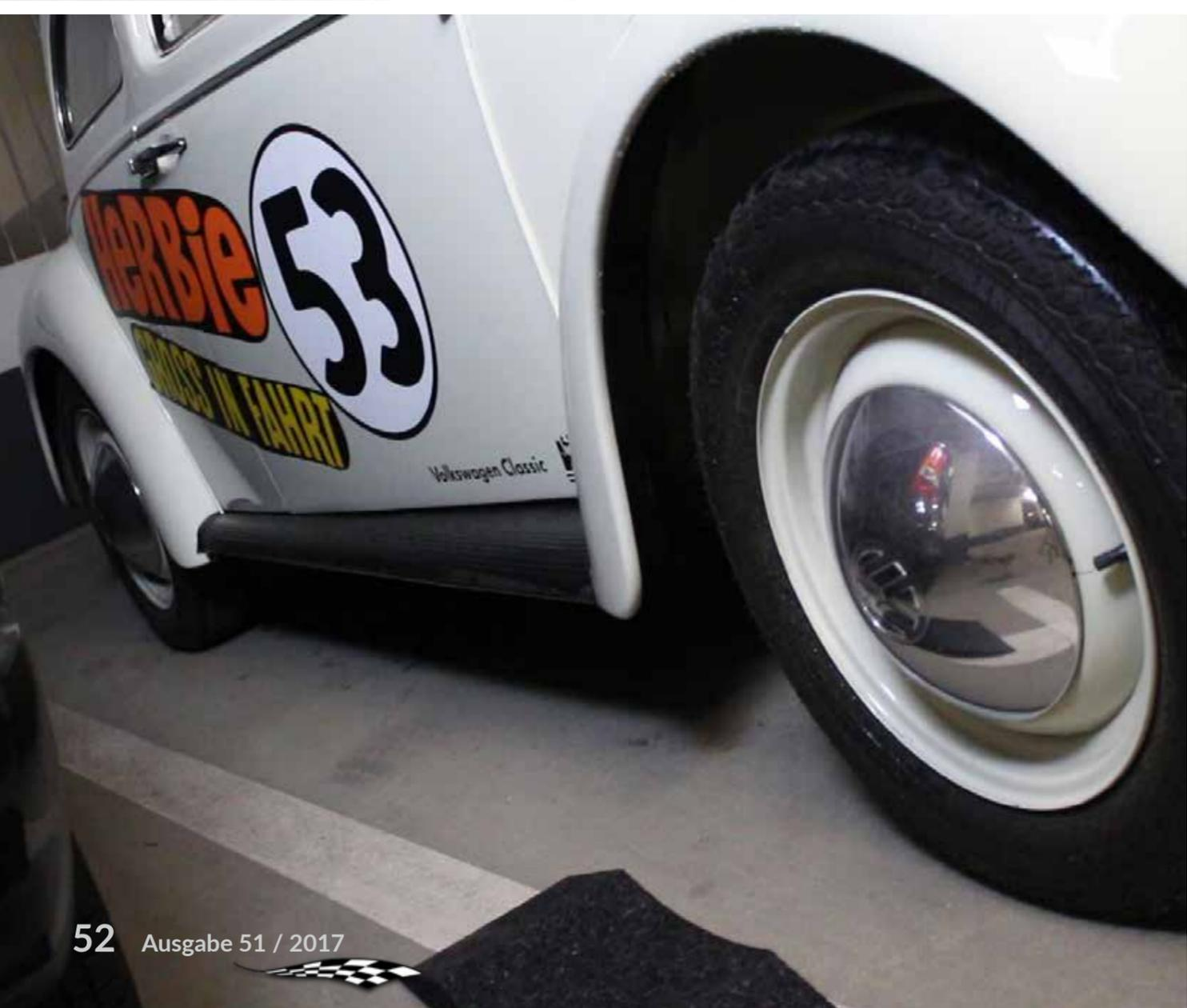
Abhilfe schaffen Reifenschalen aus Kunststoff. Solche Reifenschalen sind aus einem weichen Polymer und bieten dem Reifen die Möglichkeit, sich in die Reifenschale einzuschmiegen und somit nicht dauerhaft durch das Gewicht des Fahrzeugs gequetscht zu werden.
