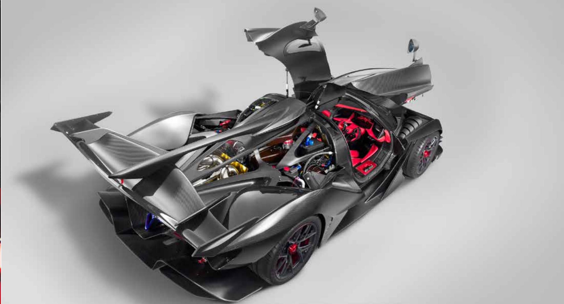
Das Auto, nach Worten des Herstellers „Treibstoff für die Sinne“, hat einiges für den Liebhaber zu bieten: Chassis und Anbauteile sind aus Carbon gefertigt, und macht aus dem Wagen ein Leichtgewicht von 1.250 kg. Weder Turbo noch Hybridsysteme treiben den IE an sondern ein 6.3-Liter V12 Motor, 760 Newtonmeter und 780 PS stark. Von 0 auf 100 km/H beschleunigt der IE in 2,7 Sekunden, die Höchstgeschwindigkeit liegt bei 335 km/H.
