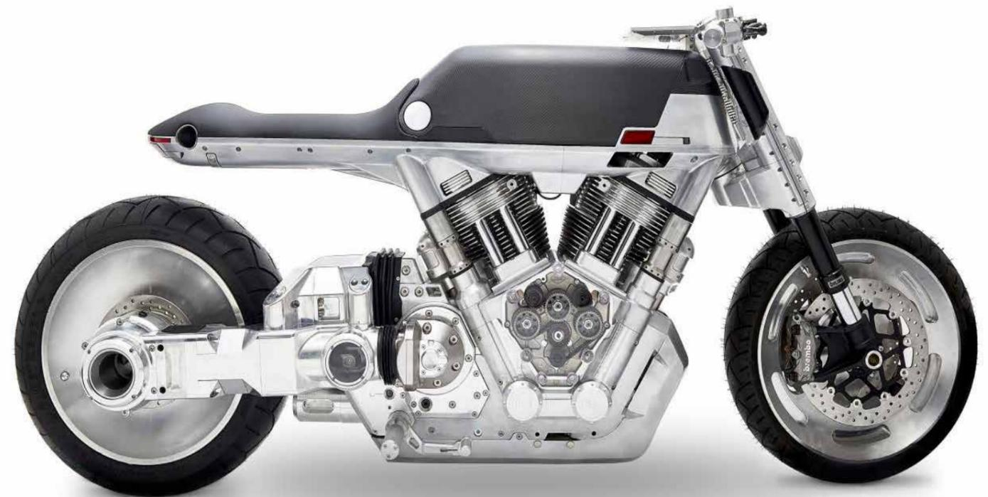
Der Antrieb läuft über eine Kardanwelle in der massiv wirkenden Einarmschwinge. Das Vanguard hat einen 100 PS starken S&S V2 Motor mit 1,7 Liter Hubraum. Rückspiegel werden durch eine Kamera ersetzt und auf das Tablet Display an der Lenker-Brücke übertragen. Das Tablet ersetzt zugleich auch alle Instrumente. Der Vanguard Roadster soll ab 2018 auf den Markt kommen.
