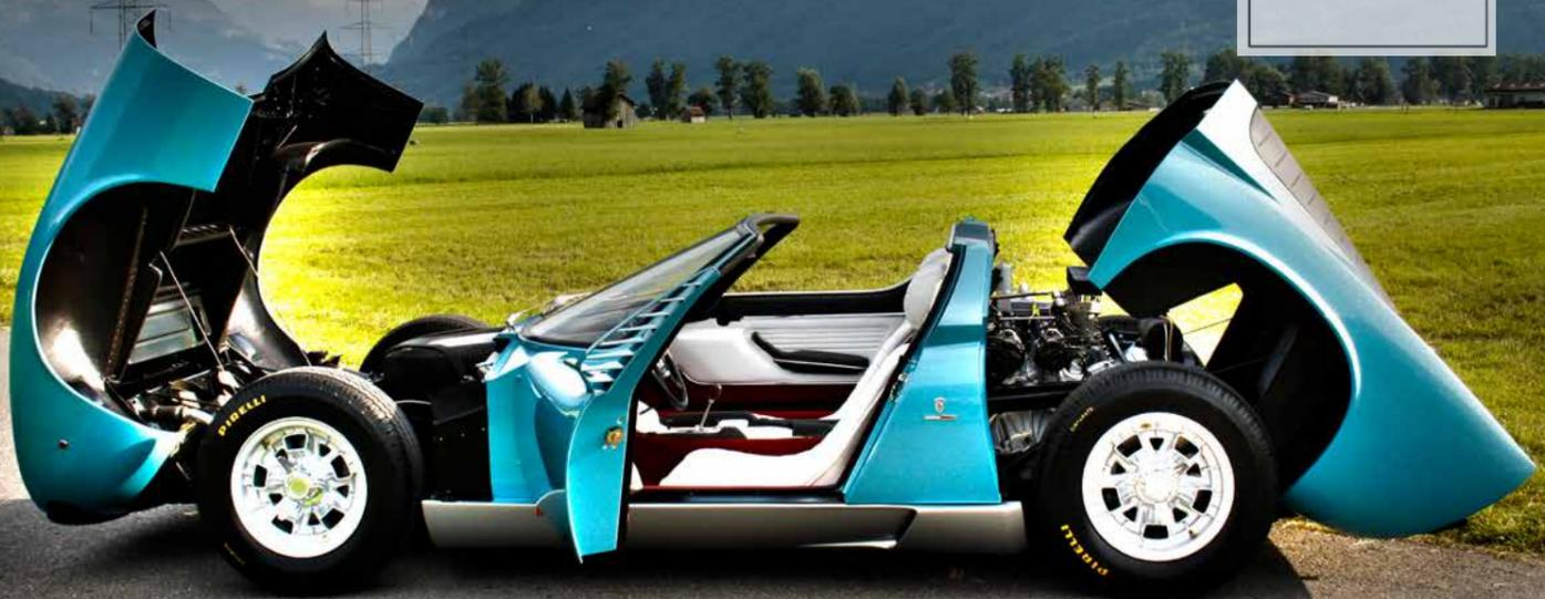
Im Heck wirkt ein 4 Liter V12 Motor mit einer Leistung von ca. 360 PS. Dies bringt diesen Supersportler auf eine Höchstgeschwindigkeit von fast 260 km/h. Auf jeder Bank versorgen 6 Weber-Doppelvergaser die Zylinder mit Kraftstoff. Von 0 auf 100 km/h beschleunigt dieses Kraftpaket in 6,2 Sekunden.
