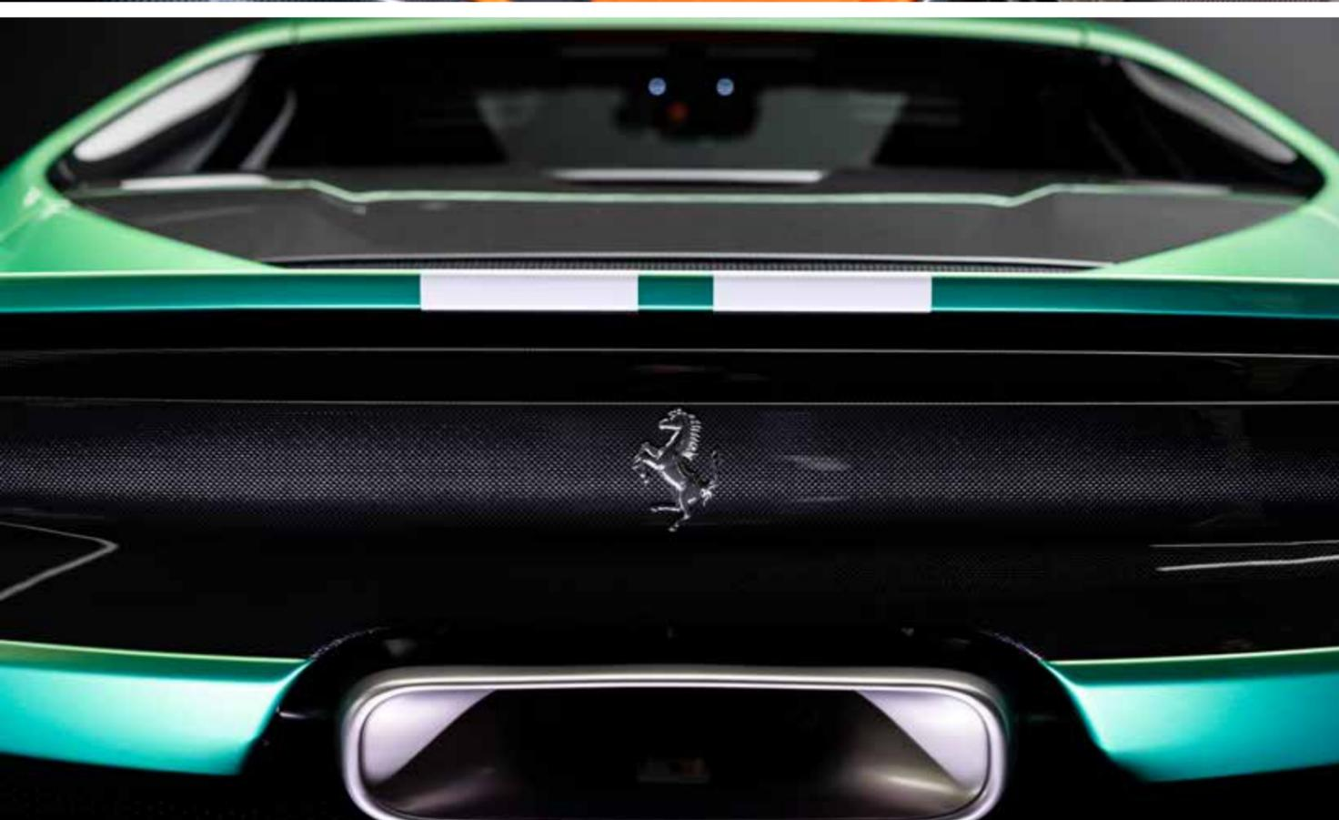
Die Aerodynamik wurde gezielt auf maximale Performance ausgelegt. Mit 435 Kilogramm Abtrieb bei 250 km/h generiert der 296 Speciale rund 20 % mehr als sein zivilisierter Bruder. Zu verdanken ist dies innovativen Lösungen wie vertikalen Finnen am Heckstoßfänger, einem aktiven Spoiler mit neuer Steuerlogik und einem neuartigen Aero-Dämpfer in der Fronthauben – allesamt Technologien, die ursprünglich für den 296 Challenge entwickelt wurden.
