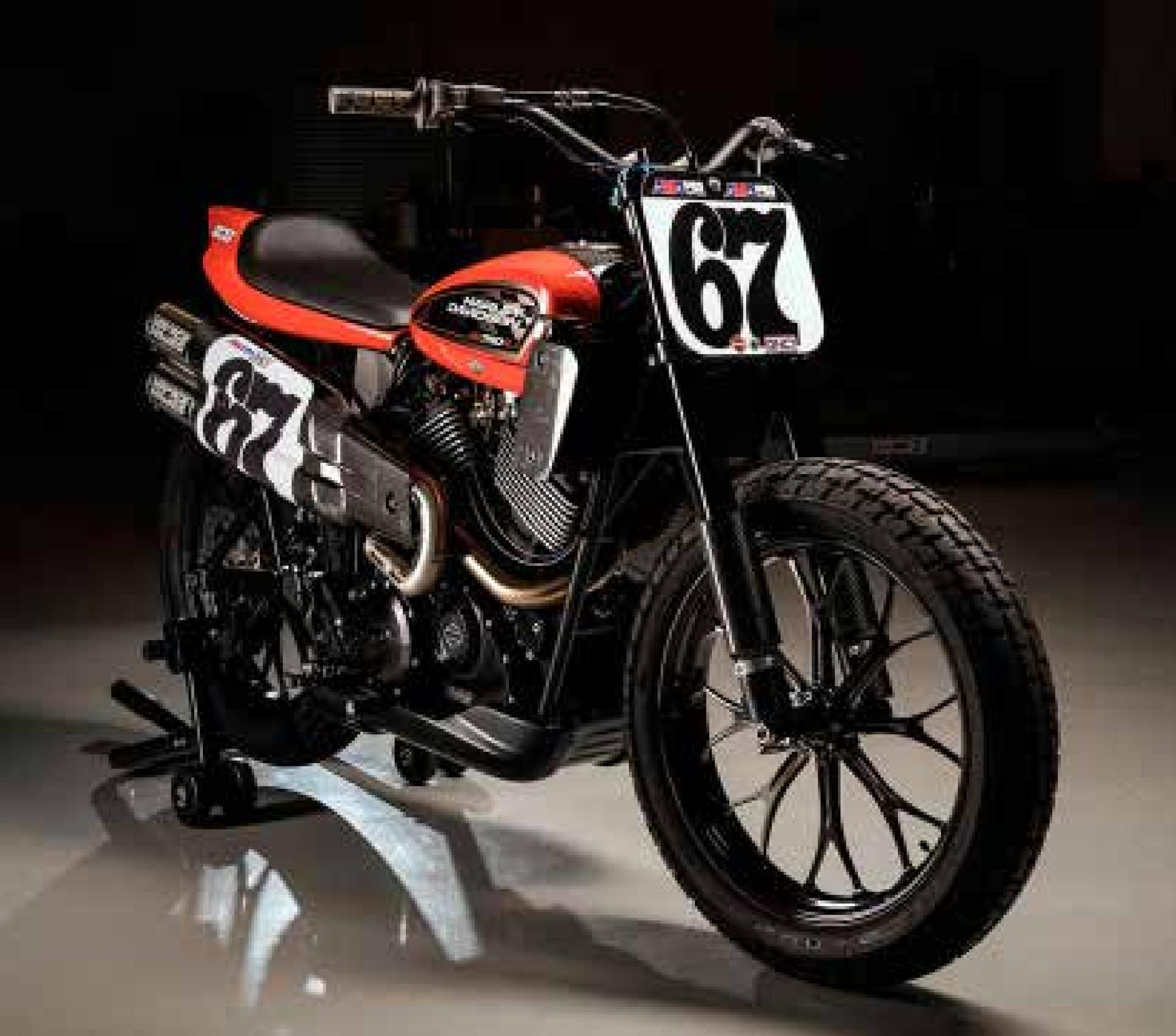
Die neue Flat Tracker wird durch einen 750ccm wassergekühlten Revolution X V-Twin Motor angetrieben, der für die Harley Davidson Street 750 entwickelt wurde, einem Motorrad, das für die optimale Straßenlage konzipiert wurde und alle Eigenschaften der Dark Custom besitzt. Der Revolution X Motor ist für den harten Kampfeinsatz auf der Rennstrecke getunt und soll dem leistungsstarken Einsatz gerecht werden.
