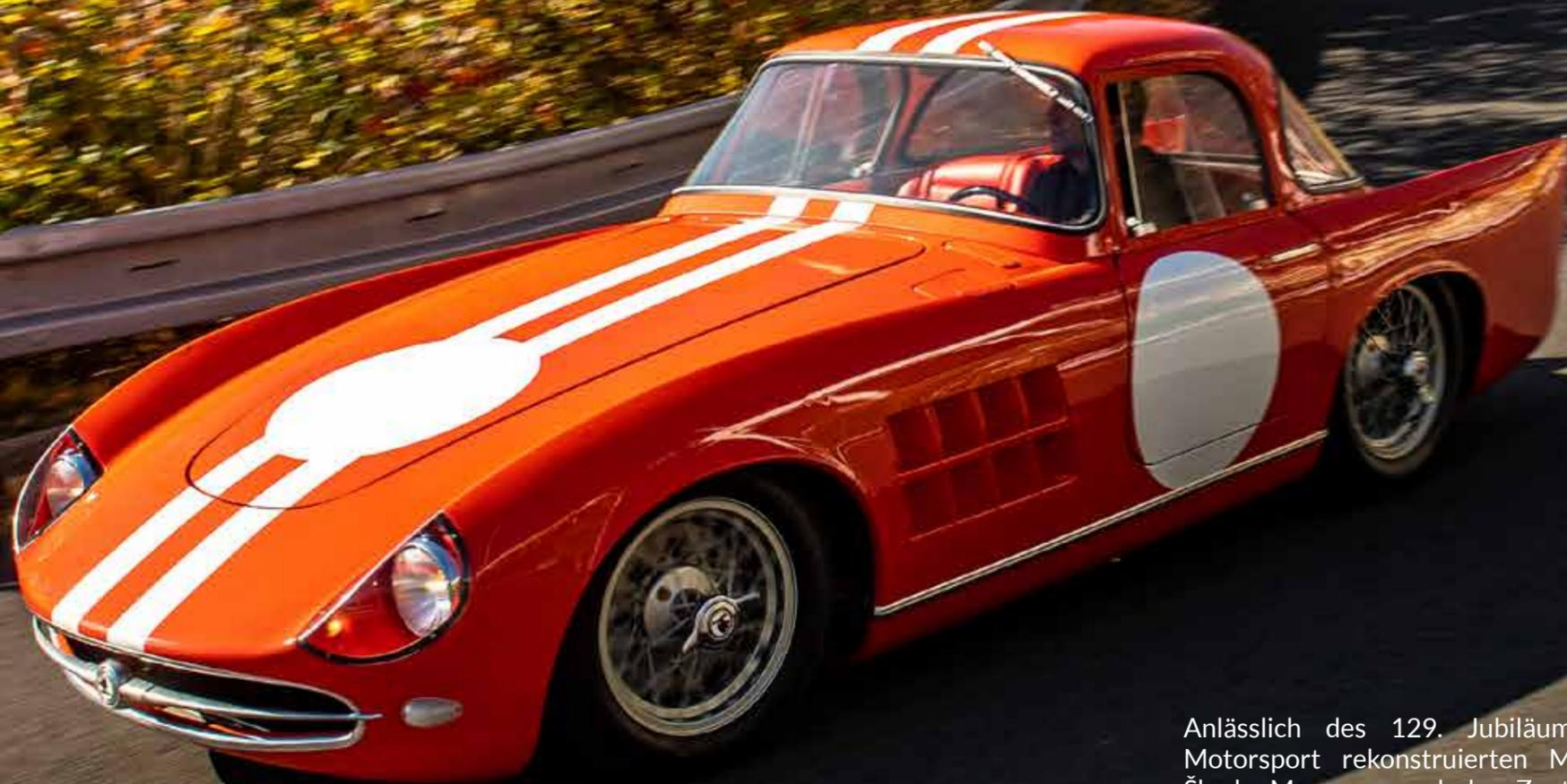
Anlässlich des 129. Jubiläums von Škoda Motorsport rekonstruierten Mitarbeiter des Škoda Museums und des Zentrums für Prototypenbau bei Škoda Auto den Rennwagen Škoda 1100 OHC Coupé. Zunächst arbeiteten die Teams an der Wiederaufbereitung des ursprünglichen Rahmens, des Fahrwerks sowie des Motors und bauten auch die Karosserie nach historischer Dokumentation wieder auf. Dabei kamen moderne Spitzentechnologien ebenso zum Einsatz wie traditionelle Techniken aus dem Karosseriebau.
