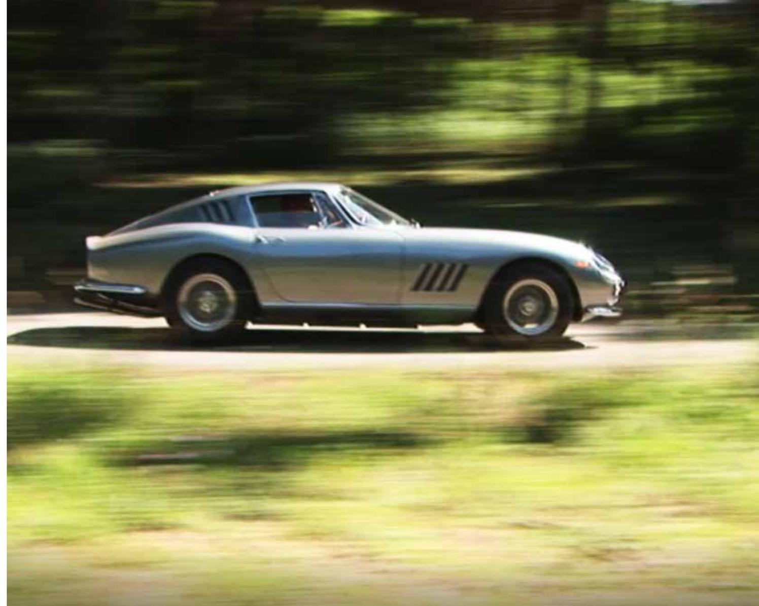
Ab 1965 wurde die 275 GTB-Version auf den Markt gebracht. Das B steht für Berlinette, ein leichtes Reise-Coupé. Ausgestattet mit einem 3268 ccm V12 Heck-Motor aus Aluminium mit 280 PS bei 7000 U/min, bringt es der ca. 1300 kg schwere Sportwagen auf gute 250 km pro Stunde. Von 0 auf 100 km/h beschleunigt die Kraftmaschine in 6,2 sec.
